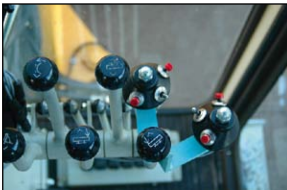
Hydraulische Bedienelemente mit angesetzter TOPCON-Bedienung
